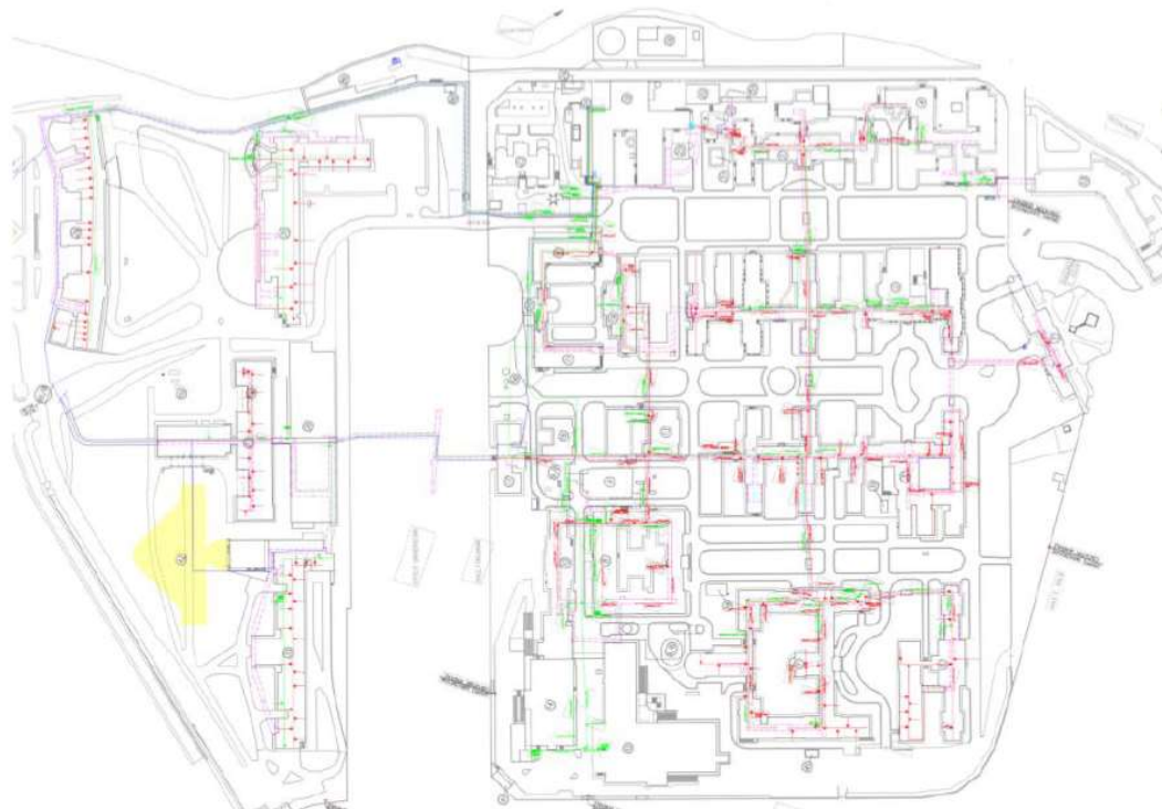
Figura 29 - Rete distribuzione vapore e acqua calda
